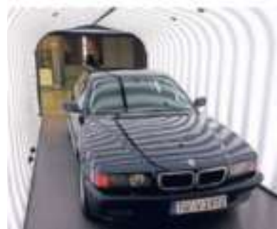
Der mobile Scanner erkennt Hagelschäden. FOTO: EPPINGER
